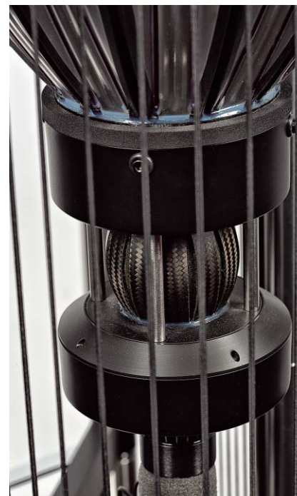
Trzy górne cebule wiszą jedna pod drugą, nie są od dołu niczym podparte; w tej sekcji układy magnetyczne poszczególnych przetworników znajdują się na górze każdego z nich.
