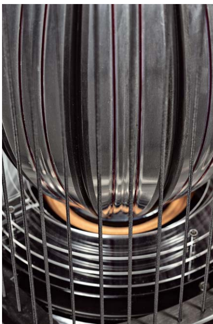
Największa cebula – niskotonowa – ma listwy aluminiowe. W tej części łączy się z cewką napędzającą, widać fragment resora podobnego jak w typowych przetwornikach.
