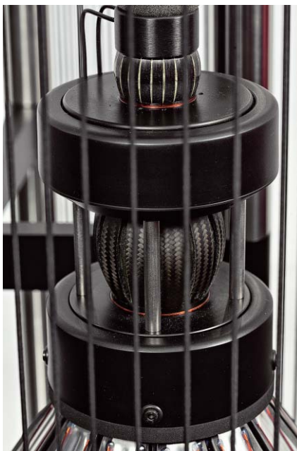
Membrany (cebulki) przetworników średniotonowego i wysokotonowego wykonano z włókna węglowego. W płaskich walcach znajdują się układy magnetyczne.
